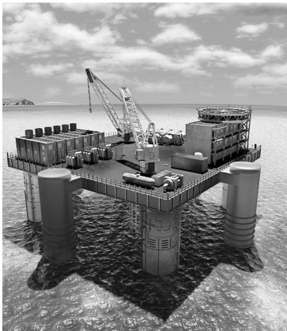
図3 ロッキード社のハワイにおける10MW OTEC 構想
