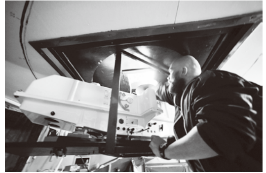
今も観測が続く、ウクライナのベルナツキー基地に設置された オゾン測定用のドブソン分光光度計
