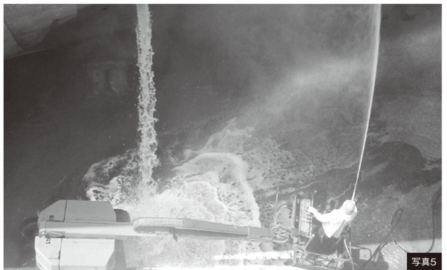
ドックでの洗浄中に放水される貨物船のバラスト水
