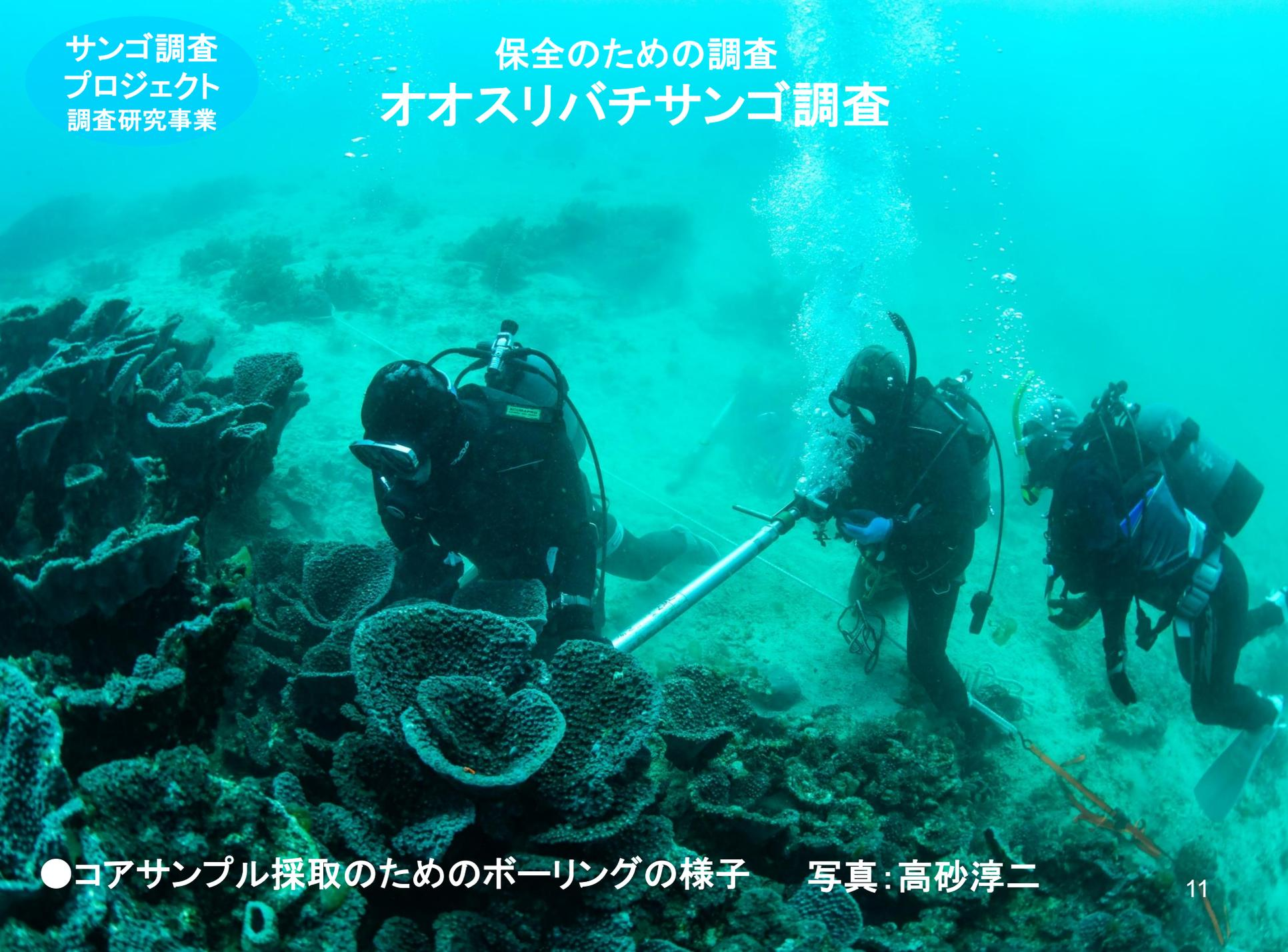
●コアサンプル採取のためのボーリングの様子 写真：高砂淳二
