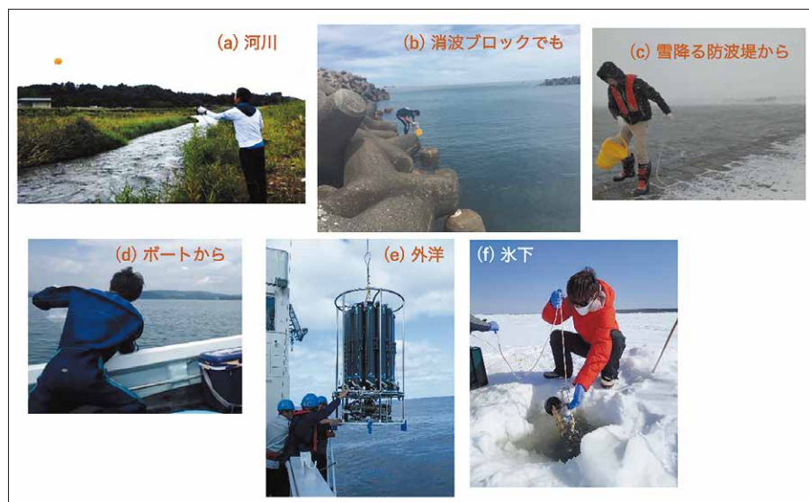
図5 いろいろな場所で環境DNA用の採水をしている様子。(e)外洋では、専用の採水器具を使えば数千メートル下の深海からも採水できる。(f) 氷に穴をあけて氷下の水を採って分析すれば、氷下に生息する生き物も分かる
