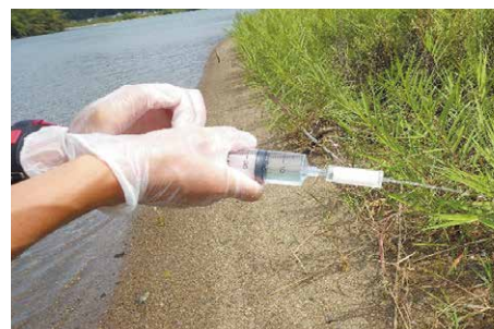
図6 採水した河川水をろ過している様子。注射筒の先についている白い物が、フィルターの入ったカートリッジ
