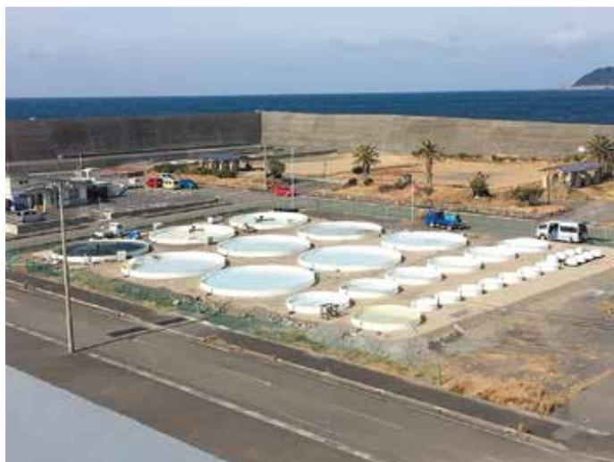
図12 高知大学発ベンチャー・合同会社シーベジタブルが運営する青海苔を安定生産するための陸上タンクシステム
