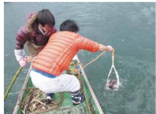
図8 胞子供給量調査でガラス板を川底に沈めて設置する様子
